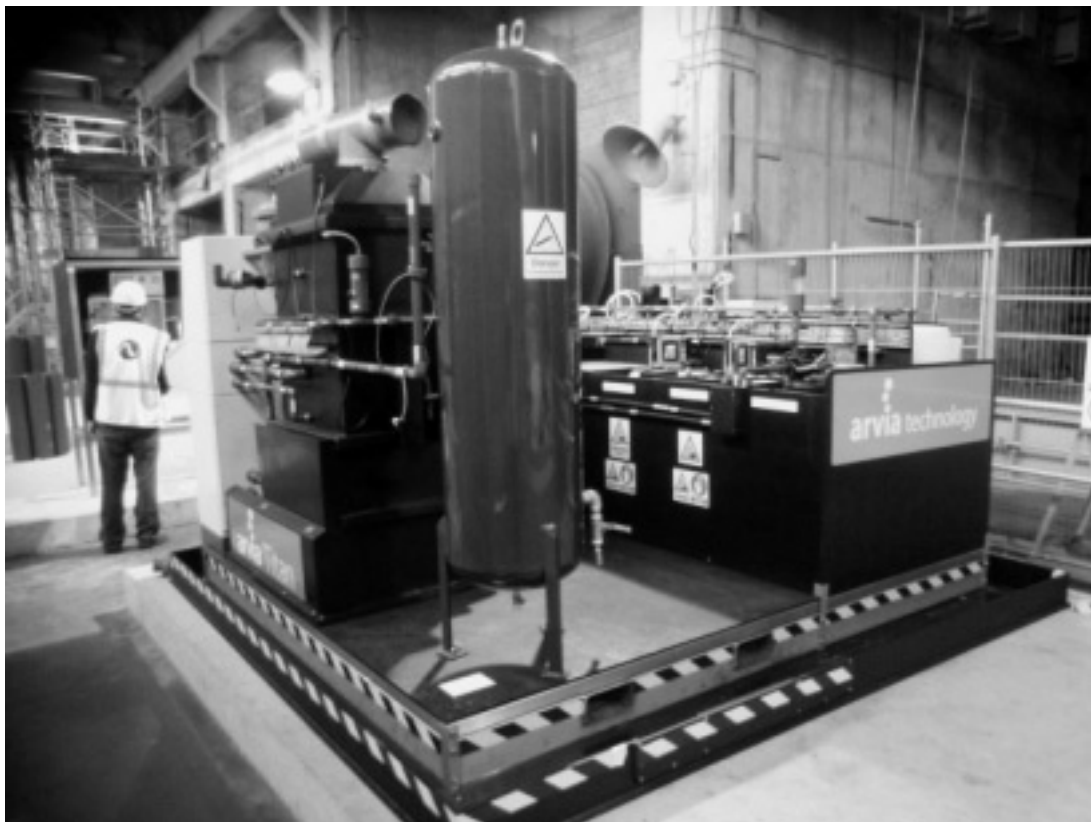
Magnoxで行われた従来処理の困難な油の分解装置
